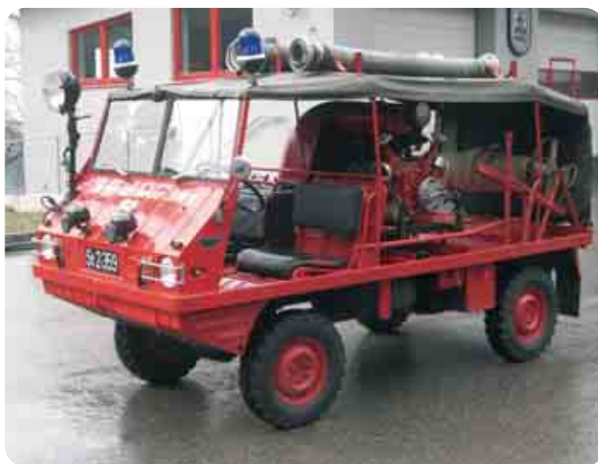
KLF-A Kleinlöschfahrzeug mit Allradantrieb Baujahr 1962
